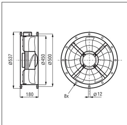
**Skříň** je z ocelového galvanizovaného plechu, opatřeného černým (variantně šedým) epoxidovým lakem, montážní konzole a šrouby jsou galvanicky pokoveny.
